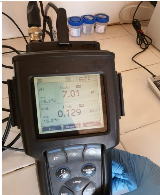
Fotografía #. Prueba de Laboratorio de Muestra “M1” Resultado de Salinidad: 0129 psu
