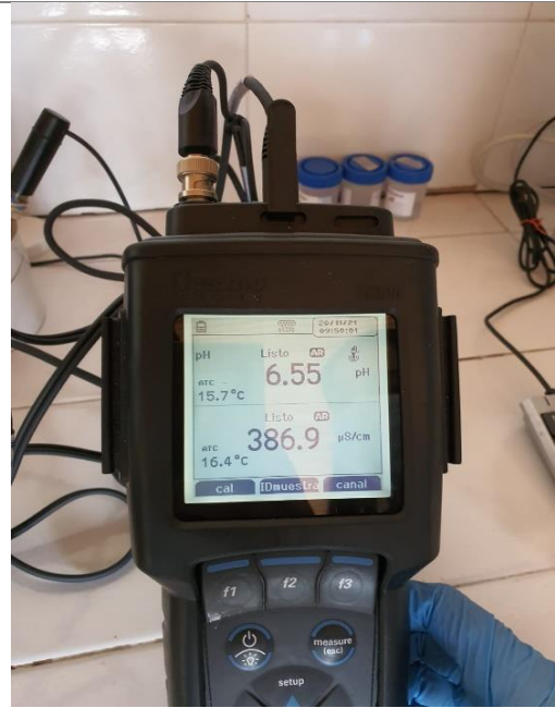
Fotografía 4. Prueba de Laboratorio de Muestra “M1” Resultado de PH:6.55 Conductividad 396.9
