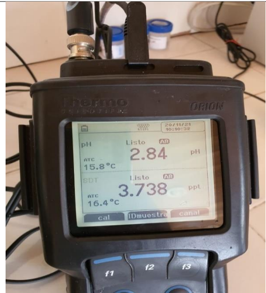
Fotografía 6. Prueba de Laboratorio de Muestra “M3” Resultado de solidos disueltos Totales: 3.738 ppT
