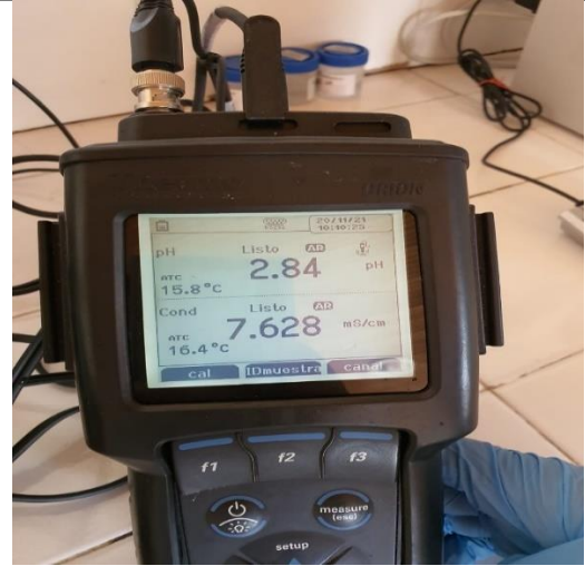
Fotografía 4. Prueba de Laboratorio de Muestra “M1” Resultado de PH:2.84 Conductividad 7.628
