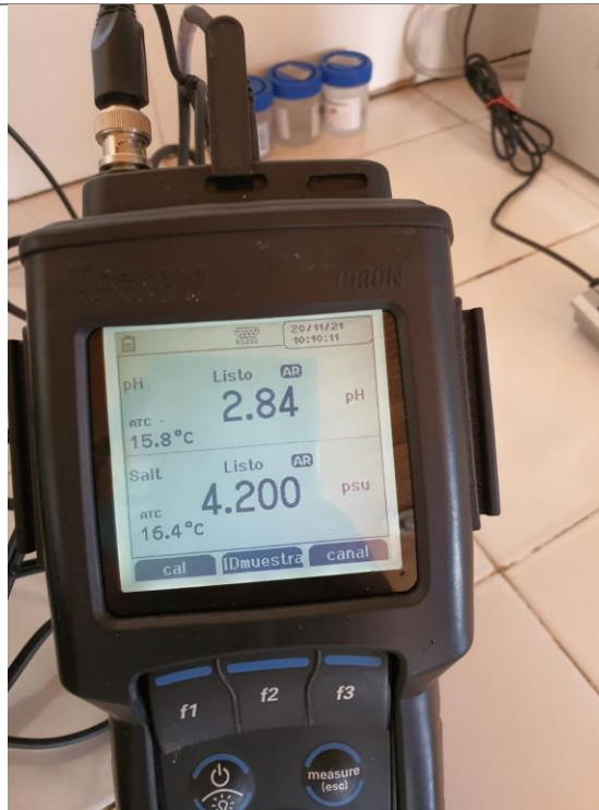
Fotografía 7. Prueba de Laboratorio de Muestra “M1” Resultado de Salinidad: 4.204 psu
