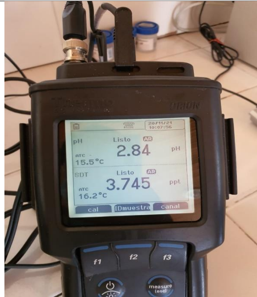
Fotografía 6. Prueba de Laboratorio de Muestra "M3" Resultado de solidos disueltos Totales 3.745 ppT
