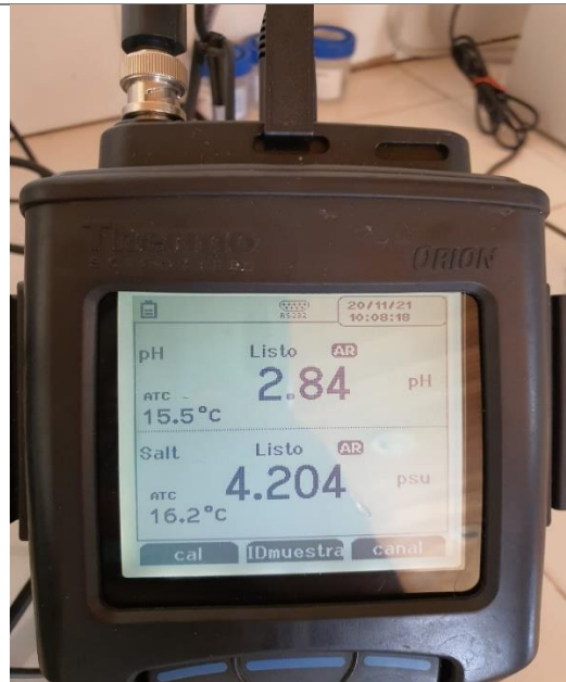
Fotografía 8. Prueba de Laboratorio de Muestra "M1" Resultado de Salinidad: 4.204 psu
