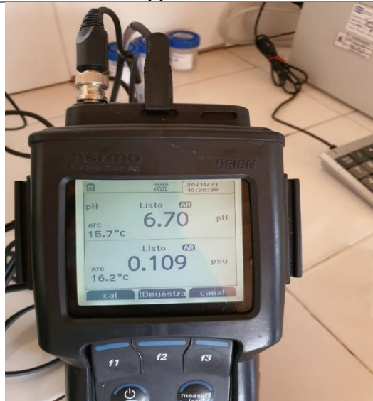
Fotografía 7. Prueba de Laboratorio de Muestra “M1” Resultado de Salinidad: 0.109psu
