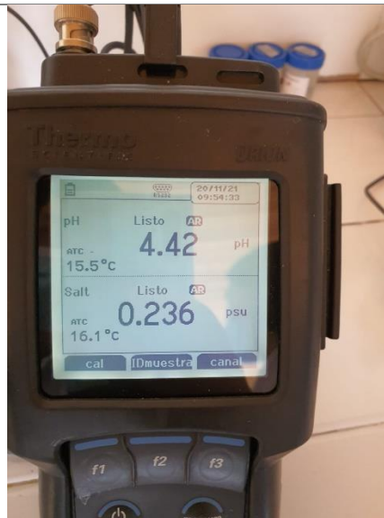
Fotografía 7. Prueba de Laboratorio de Muestra “M1” Resultado de Salinidad: 0236 psu
