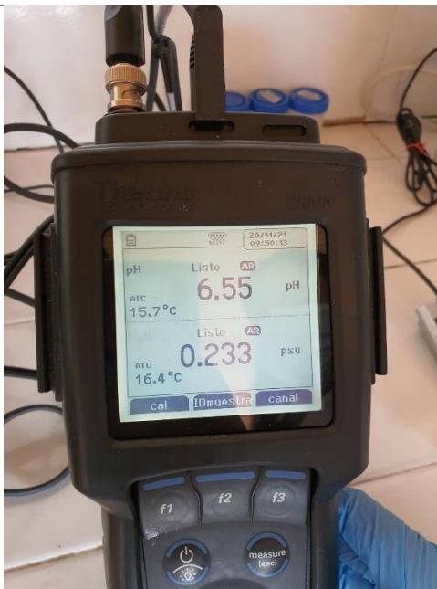
Fotografía 7. Prueba de Laboratorio de Muestra “M1” Salinidad: 0.233 psu
