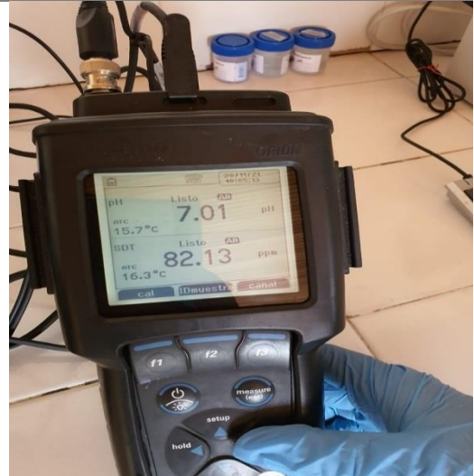
Fotografía 5. Prueba de Laboratorio de Muestra “M3” Resultado de solidos disueltos Totales: 82.13 ppm
