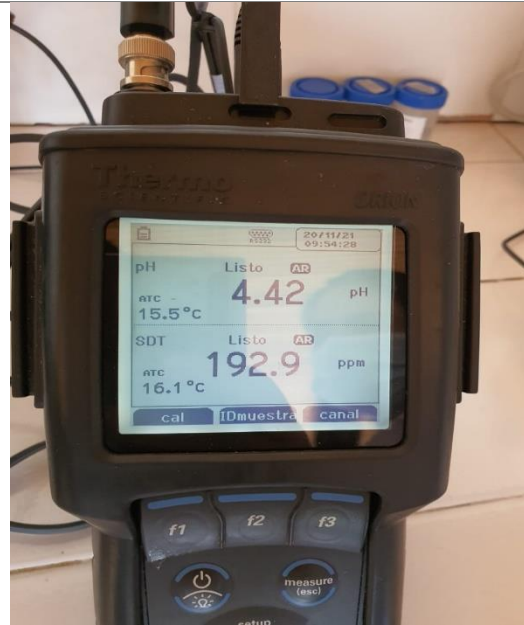
Fotografía 6. Prueba de Laboratorio de Muestra “M1” Resultado de solidos disueltos Totales: 192.9 ppm
