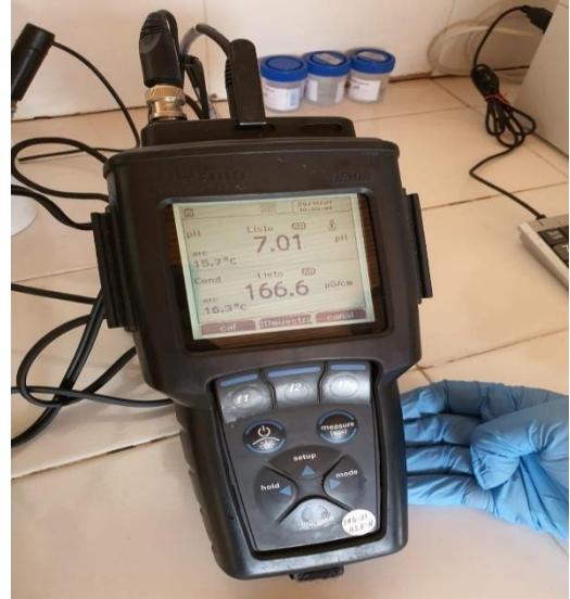
Fotografía 4. Prueba de Laboratorio de Muestra “M3” Resultado de PH:7.01, Conductividad 166.6
