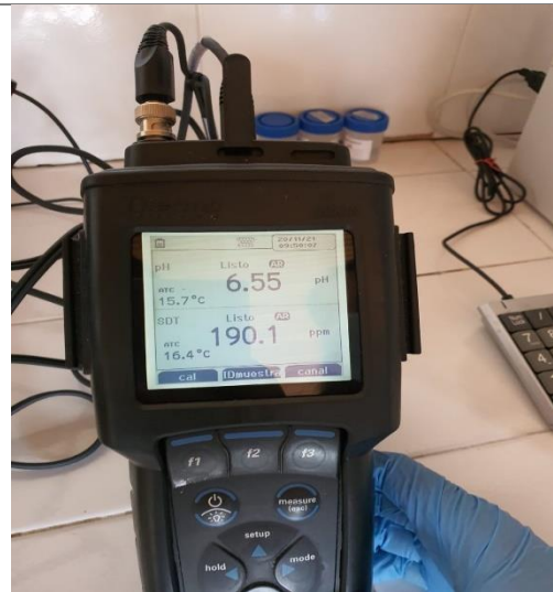
Fotografía 6. Prueba de Laboratorio de Muestra “M1” Solidos Totales Disueltos: 190.1ppm
