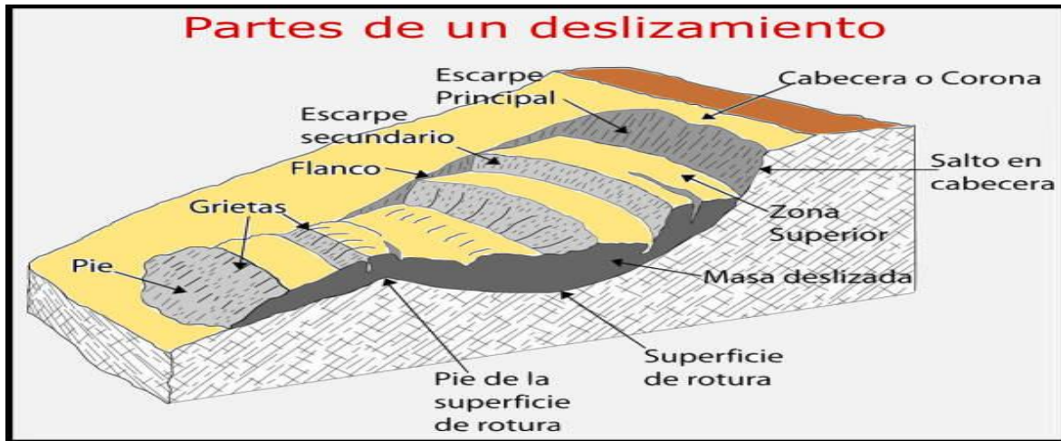
Figura 3. Partes de un deslizamiento.
