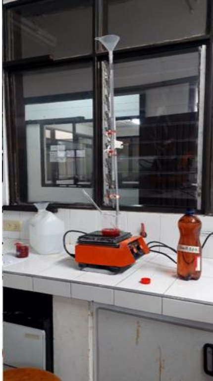
Figura 12. Obtención de la acidez total titulable de los frutos mediante titulación.
