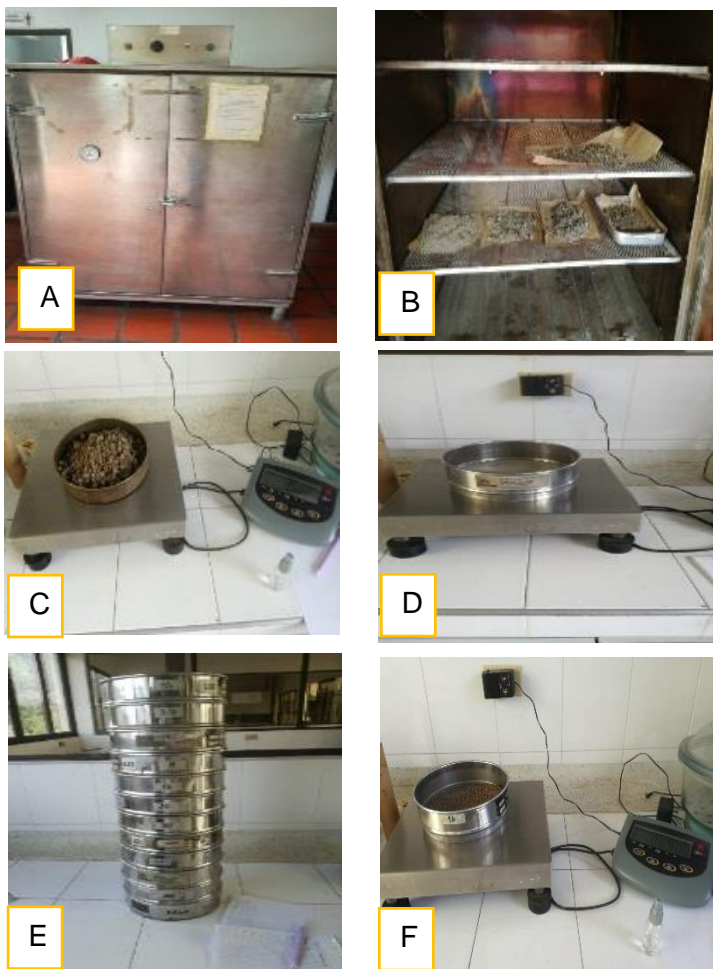
Figura 13: Análisis Granulométrico(A) Horno con las muestras, (B)Muestras secas, (C)Peso 1 kg de muestra(D)Peso Tamiz vacío, (E)Columna de tamices, (F) Peso Tamiz con la muestra
