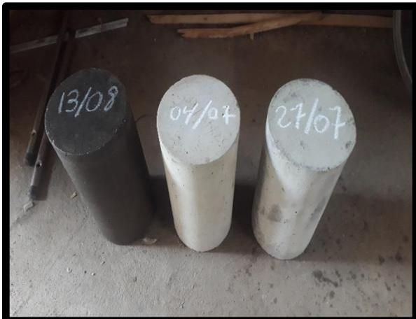
**Figura 57: Desencofrado de los cilindros.**
