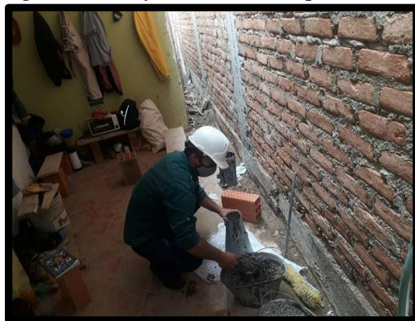
**Figura 52: Ensayo cono Slump.**
