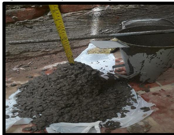
**Ensayo de resistencia a la compresión:** se procedió a tomar la muestra para el cilindro, cuando el mixer se encontraba por mitad de la mezcla llevada a la obra, se realizó el ensayo de resistencia, comprobando que se estuviera cumpliendo con lo establecido por las normas técnicas colombianas, NTC 550; luego de esto se gestionó por parte del estudiante la prueba de los cilindros, siendo conscientes que el ultimo cilindro no cumplida con los 28 días recomendados.
