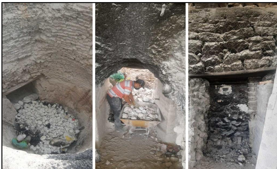
Figura 8: Llenado Del Horno Con La Piedra Y Carbón.
