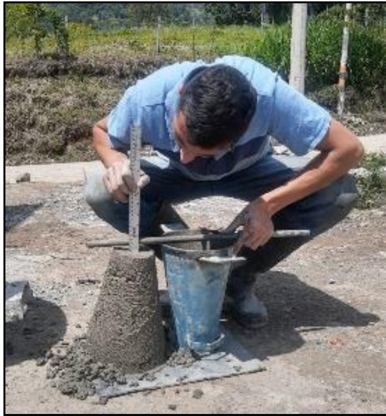
Figura 26: Medición Del Asentamiento de M-1.
