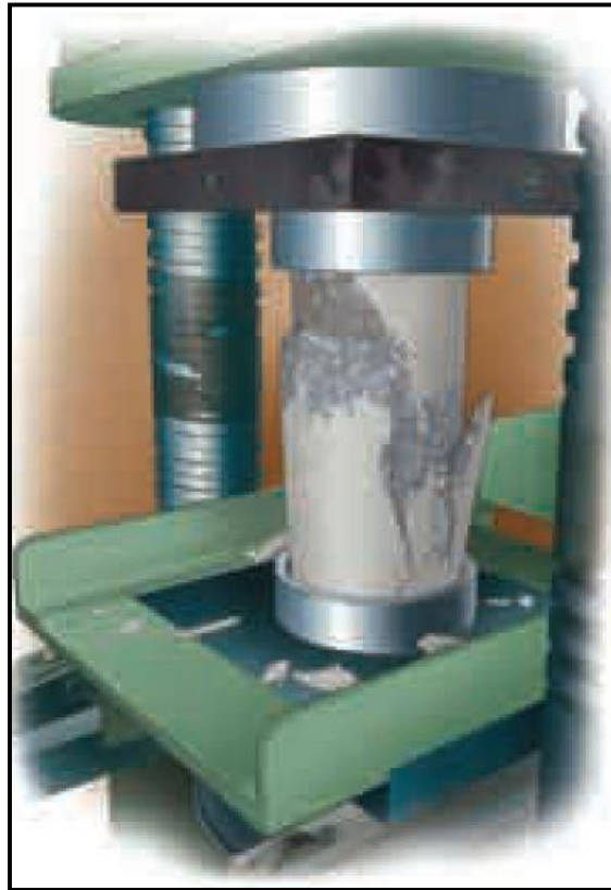
Figura 11: Ensayo de resistencia a la compresión.
