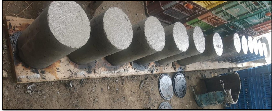
Figura 29: Desencofrado De Los Cilindros M-1.
