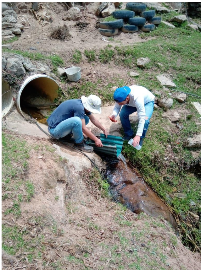
Figura 16. Aforo de caudales en la parte baja de la microcuenca Jurado
