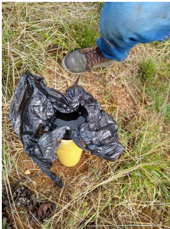
Figura 22. Prueba de infiltración en campo
