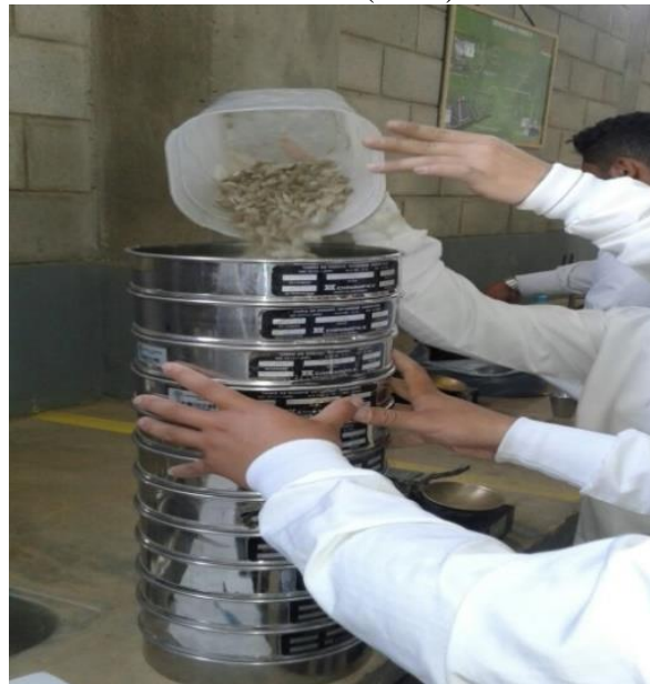
Figura 13. Ensayo de granulometría
