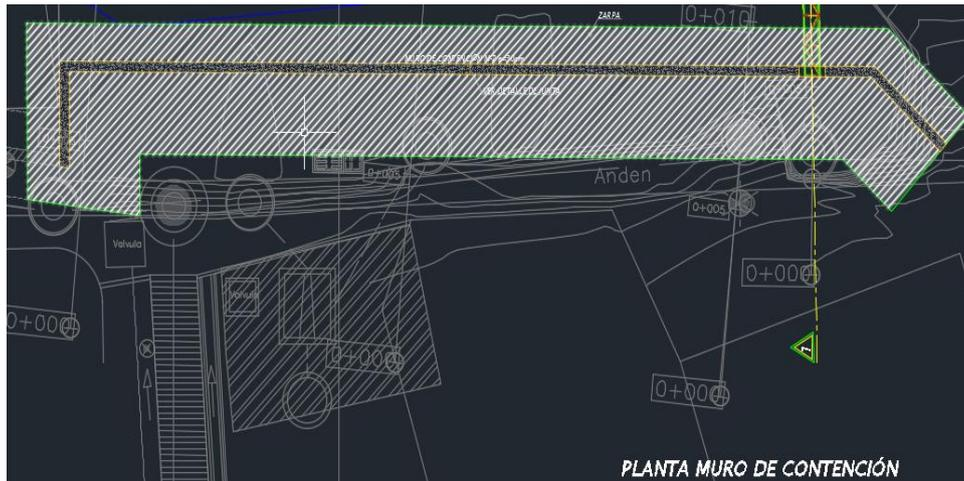
Ubicación del muro de contención, el tramo 1 va desde el extremo izquierdo hasta el centro de este, se puede observar la forma que tendrá el muro desde una vista superior. Fuente: EMCALI
