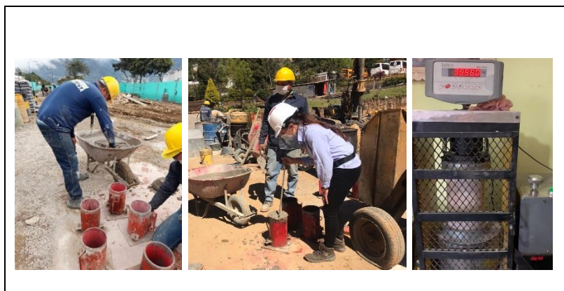
Figura 31 Procedimiento ensayo de resistencia
