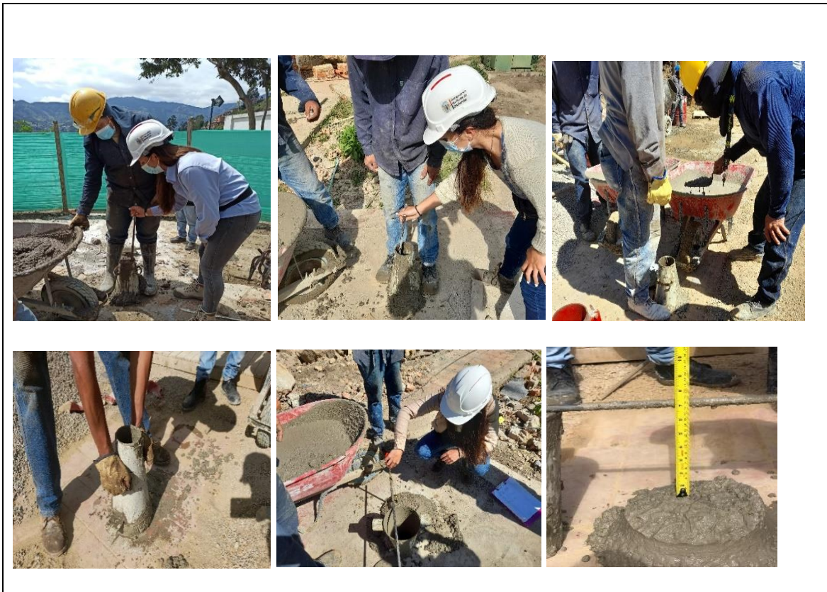
Figura 30 Procedimiento de ensayo de asentamiento
