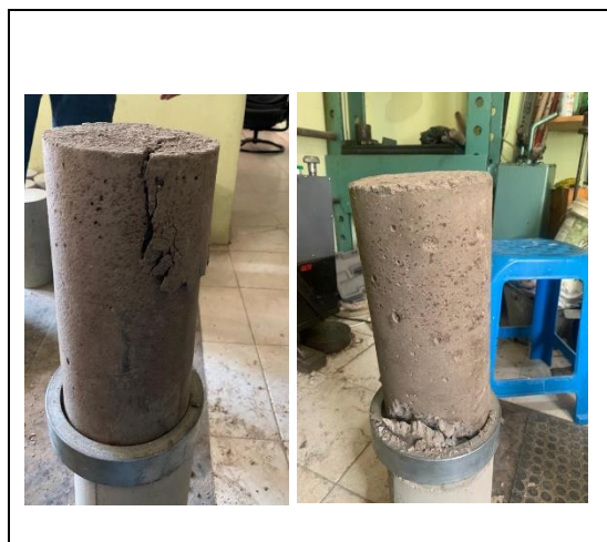
Figura 33 Modo de falla de los cilindros
