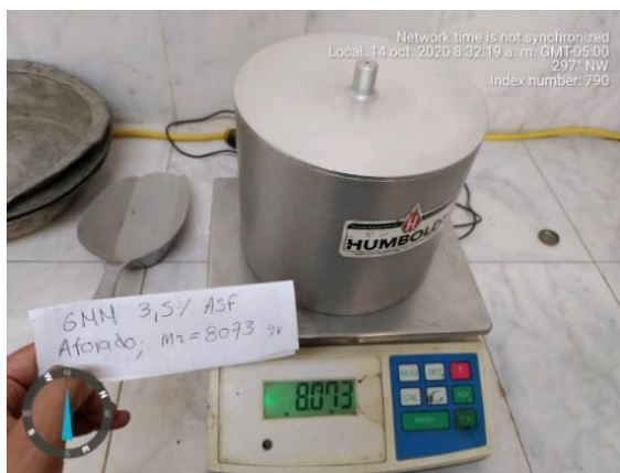
Figura 68, Gmm muestra de asfaltita con 3.5% de asfalto añadido m2(asf real 4.5).
