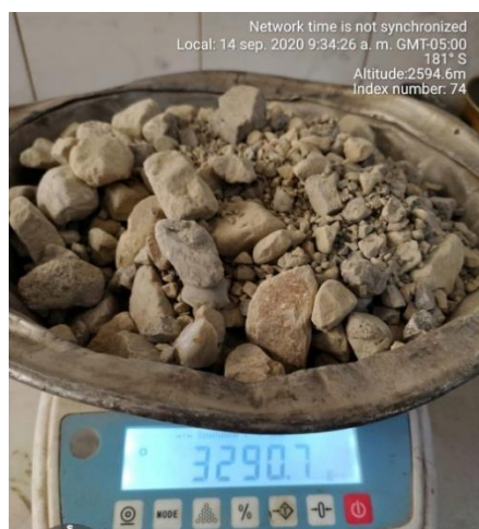
Figura 41, Muestra desgastada pasada por el tamiz N° 12.
