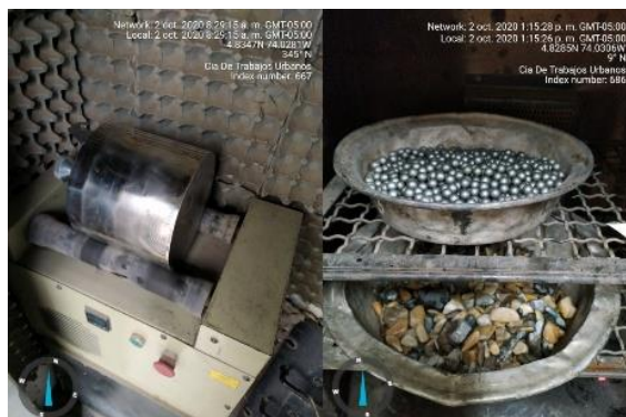
Figura 46, Peso de esferas e introduccion de mezcla mas adición de agua.
