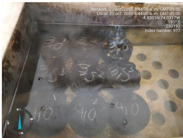
Figura 73, Inmersión de briquetas en agua a 60 °C.
