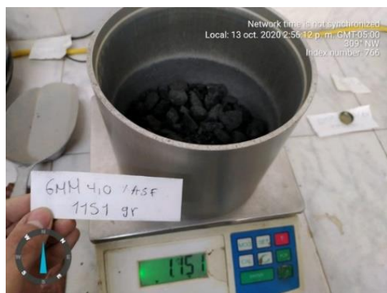
Figura 68, Gmm muestra de asfaltita con 3.5% de asfalto añadido m2(asf real 4.5).
