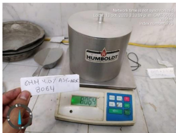
Figura 69, Gmm muestra de asfaltita con 4.0% de asfalto añadido m1(asf real 5).
