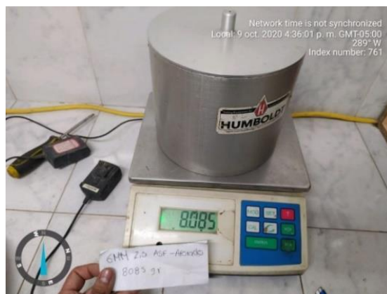
Figura 63, Gmm muestra de asfaltita con 2.5% de asfalto añadido m2(asf real 3.5).
