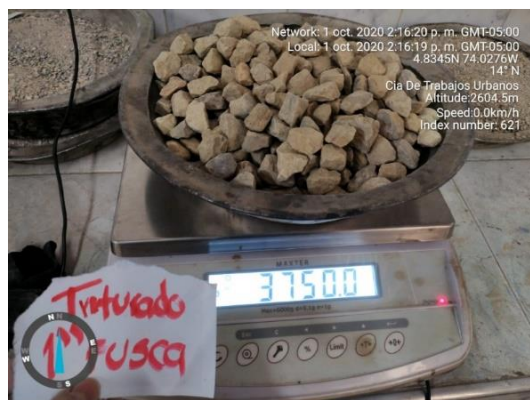
Figura 36, triturado fusca 1" equivalente al 25% de la muestra del diseño.
