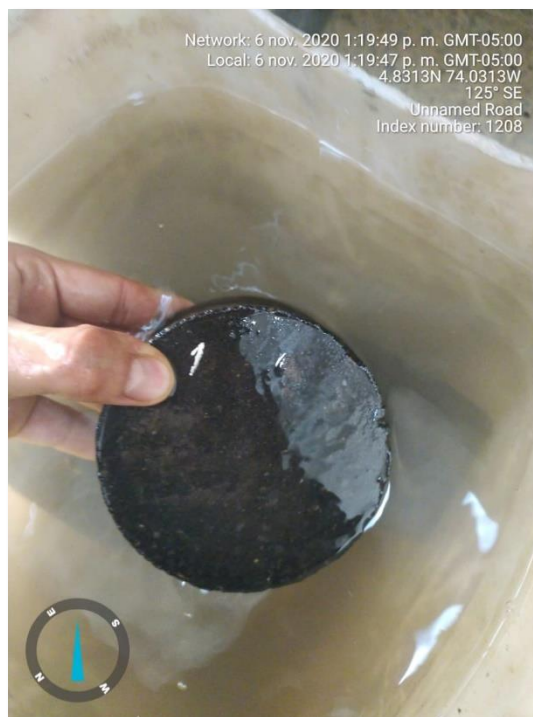
Figura 82, Briqueta 1 para TSR en humedo.
