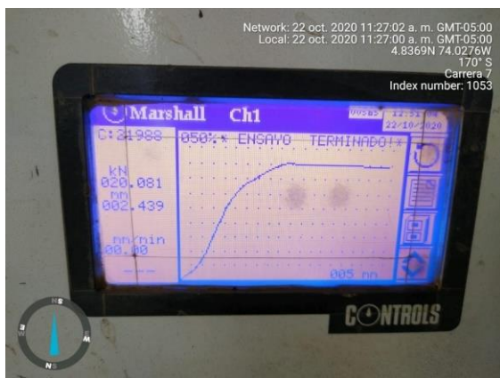
Figura 76, Estabilidad y flujo briquetas con 2.5% de asfalto añadido (asf real 3.5).
