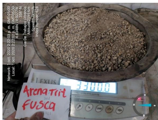
Figura 37, arena de Guayuriba triturada equivalente al 13% de la muestra del diseño.
