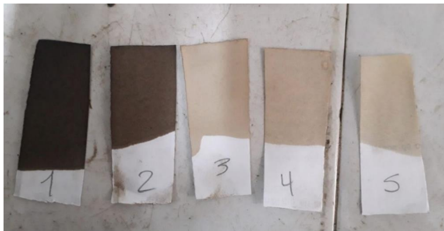
Figura 89, Extracción de asfalto, indicador suciedad gasolina.
