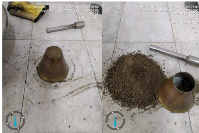
Figura 51, Prueba cono con arena.
