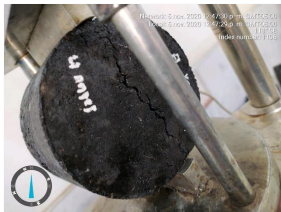
Figura 78, Fallo Briqueta N4 en Seco.
