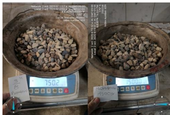
Figura 44, Peso agregados para microdeval.
