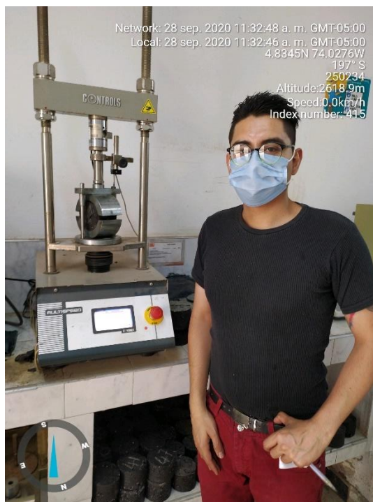
Figura 100. Prensa para Marshall y TSR. Elaboración propia.
