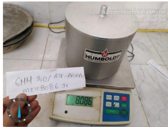
Figura 65, Gmm muestra de asfaltita con 3.0% de asfalto añadido m1(asf real 4).
