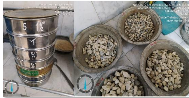
Figura 43, Juego de tamices micro de val, y separacion de tamaños de agregados.
