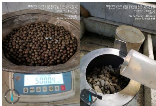
Figura 46, Peso de esferas e introduccion de mezcla mas adición de agua.
