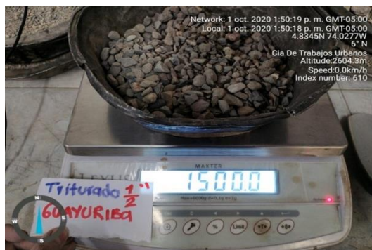
Figura 33, triturado Guayuriba \frac{1}{2} " equivalente al 10% de la muestra del diseño
