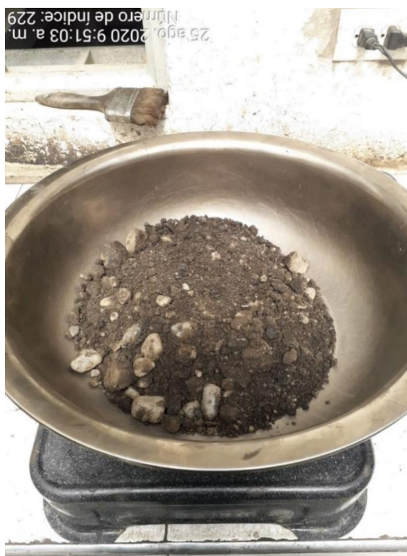
Figura 90, Cocineta con Asfaltita.
