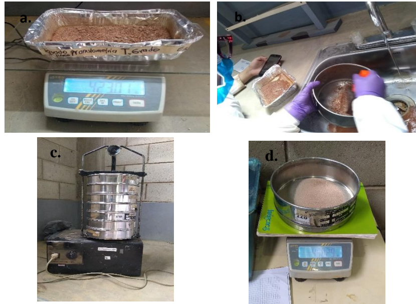
Figura 9 Ensayo de granulometría, a. pesado de la muestra, b. lavado de la muestra, c. tamizado de la muestra, d. material retenido en cada tamiz.
