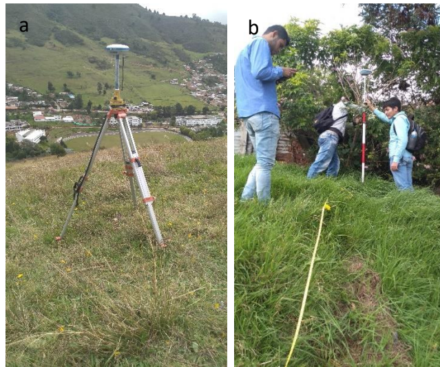
Figura 12 Equipo topográfico RTK Stonex S800 GNSS, a. estación base; b. estación móvil.
