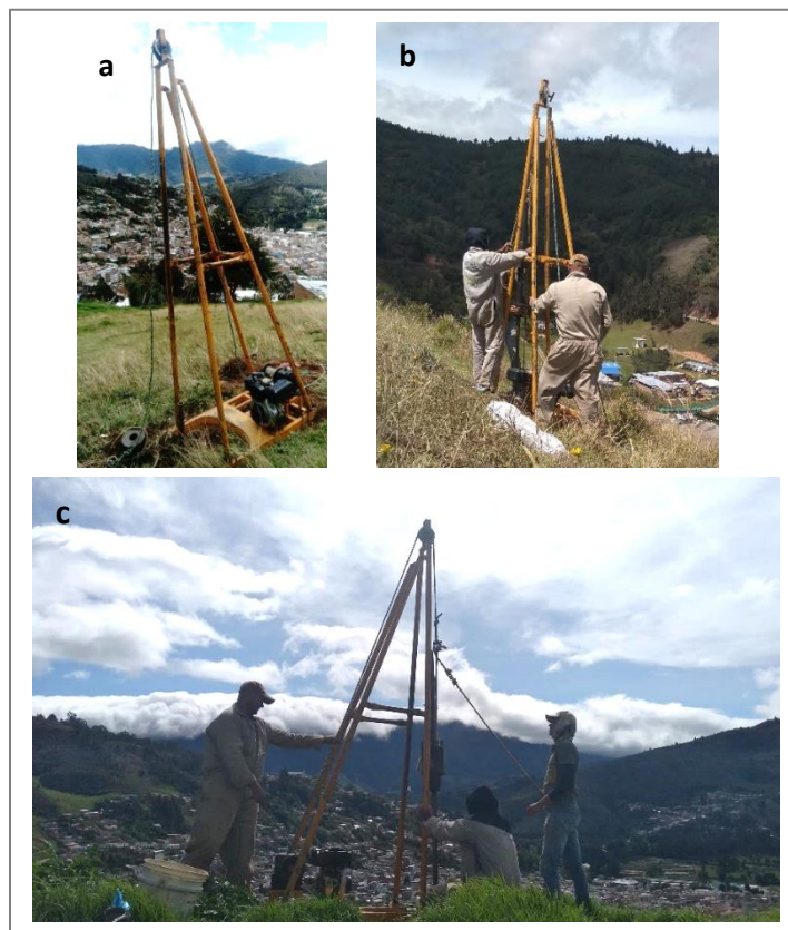
Figura 16 Equipo de ensayo de penetración estándar (SPT)
