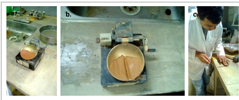
Figura 8 Limites de Atterberg, a y b. determinación del limite liquido, c. limite plástico.
