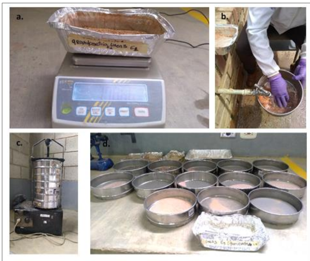
Figura 5 Ensayo de granulometría, a. pesado de la muestra, b. lavado de la muestra, c. tamizado de la muestra, d. material retenido en cada tamiz.
