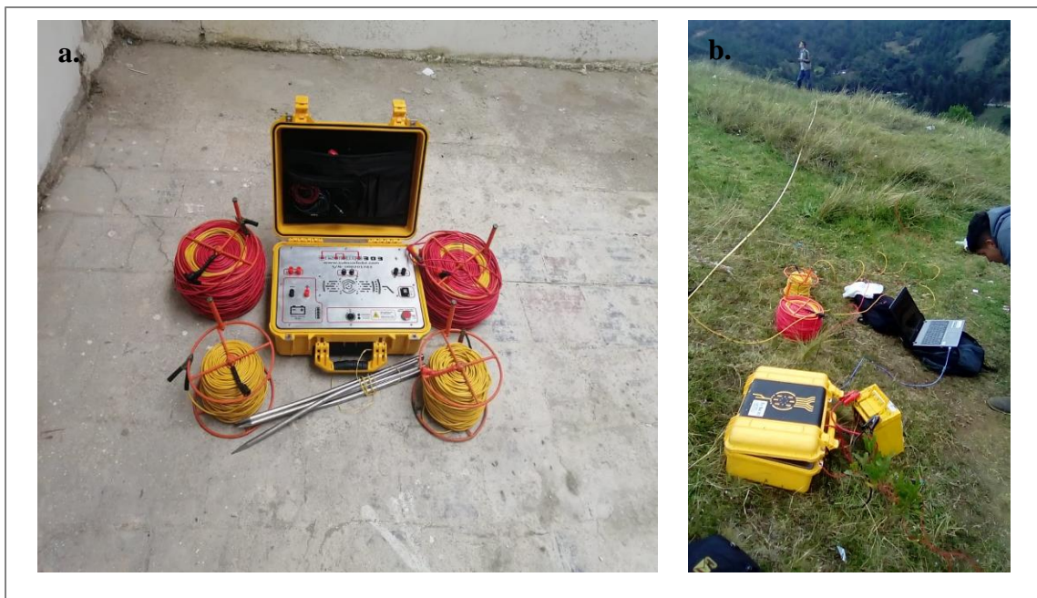
Figura 18 Sondeo eléctrico vertical, a. Equipo geoelectrónica (GeoAmp), b. adquisición de datos eléctricos
