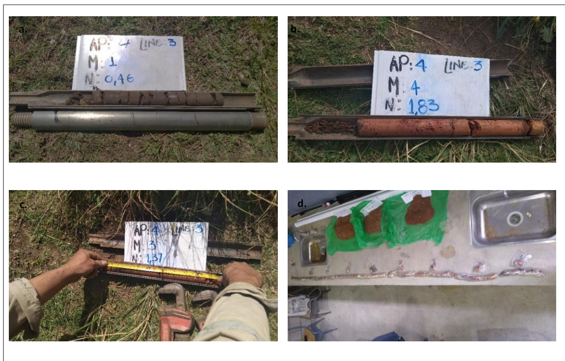
Figura 17 Muestra recuperada de ensayo de penetración estándar (SPT); a. Apique 4, muestra 1, profundidad 0.46m; b. Apique 4, muestra 4, profundidad 1.83m; c. longitud de la muestra del apique 4, muestra 3, profundidad 1.37; d. Muestra total recuperada.
