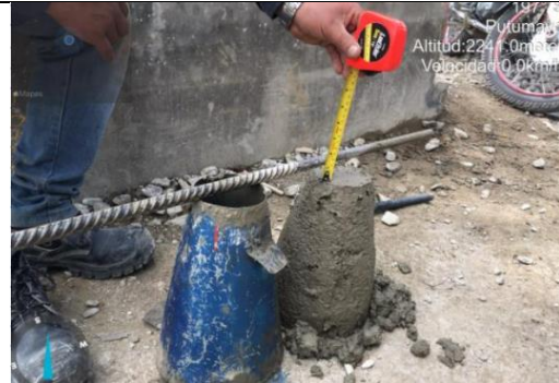
Figura 25. Toma de medida de asentamiento
