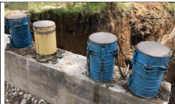
Figura 28. Toma de muestras de cilindros.
