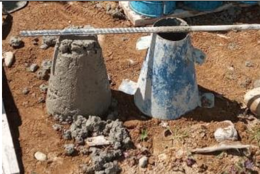
Figura 24. Toma de muestra ensayo de asentamiento
