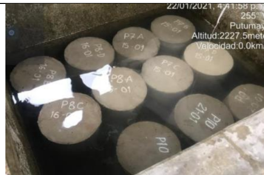
Figura 29. Curado de cilindros
