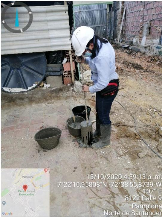
Ilustración 273: *Ensayo resistencia del concreto*
