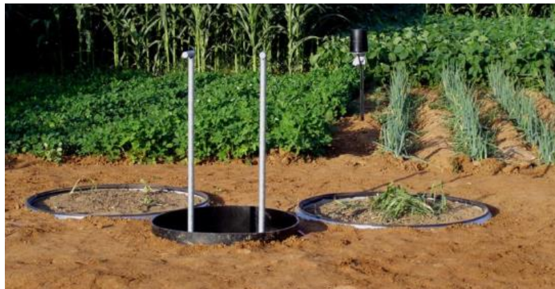
Ejemplo de instalación de lisímetro para medir ET.
