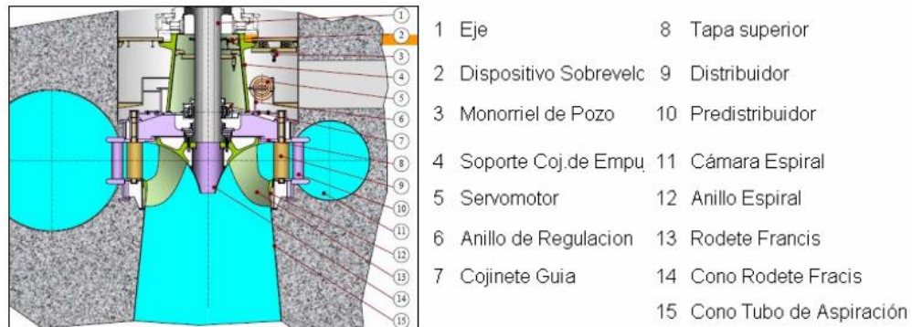
figura 7 componentes de una turbina Francis (Betancur & Esteban, 2006)
