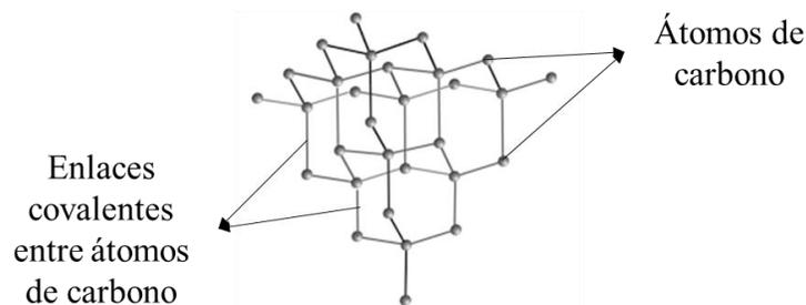
*Figura 2. Estructura cristalina del diamante. Fuente: autor*
