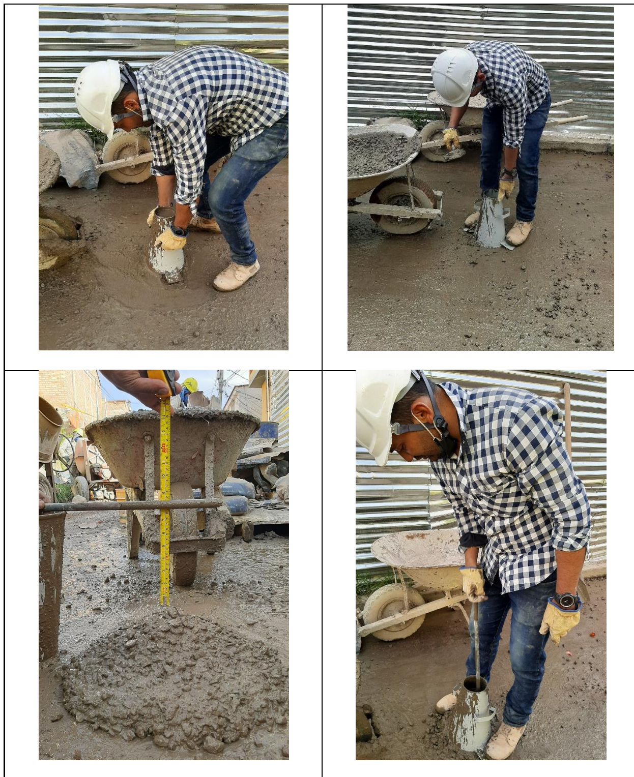
Ilustración 42. Ensayo de Slump
