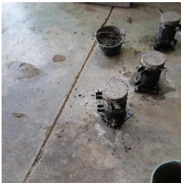
*Nota.* En la Figura 57 se presentan tres muestras cilíndricas del concreto colocado en obra
