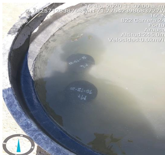
Ilustración 63: curado especímenes de concreto. Sarmiento Gonzalo (2020)
