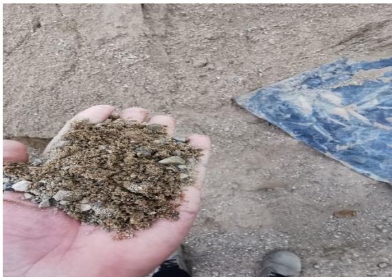
Ilustración 46. Verificación de material triturado.
