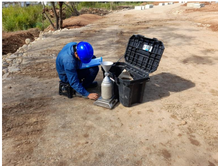
Ilustración 56. Toma de densidades a crudo de río T.M. 4" K 0+660.
