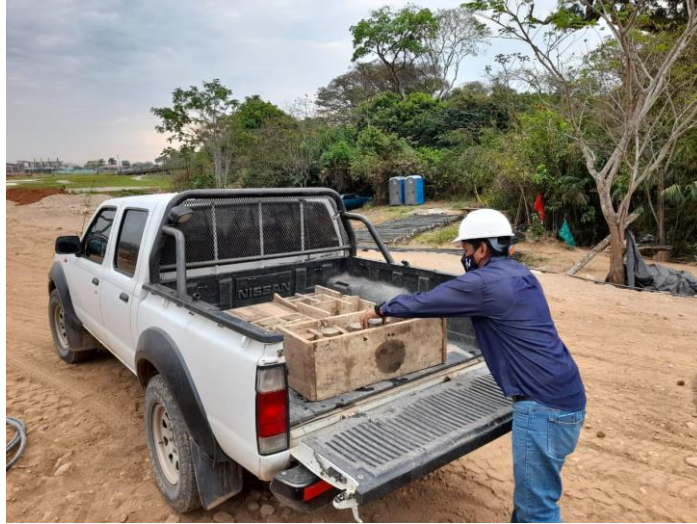
Ilustración 55. Transporte de probetas de concreto D4”.
