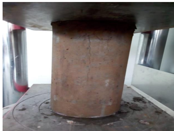
Ilustración N°18 Modo de falla en probeta
