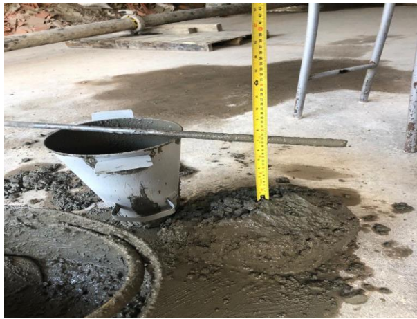
Ilustración N°11 Medición del asentamiento
