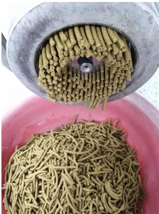
*Ilustración 9.* Peletización en molino industrial. Diego Díaz (2020)
