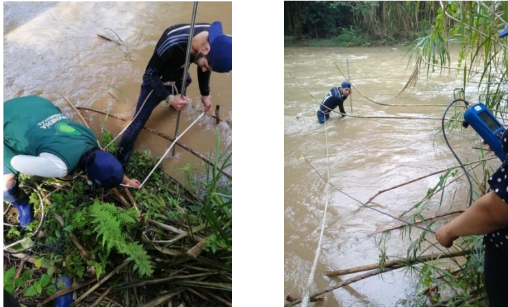
Figura 38. Medición en campo de aforos.
