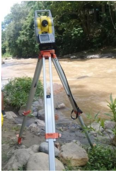
Figura 35. Estación Total de Topografía usada en campo.
