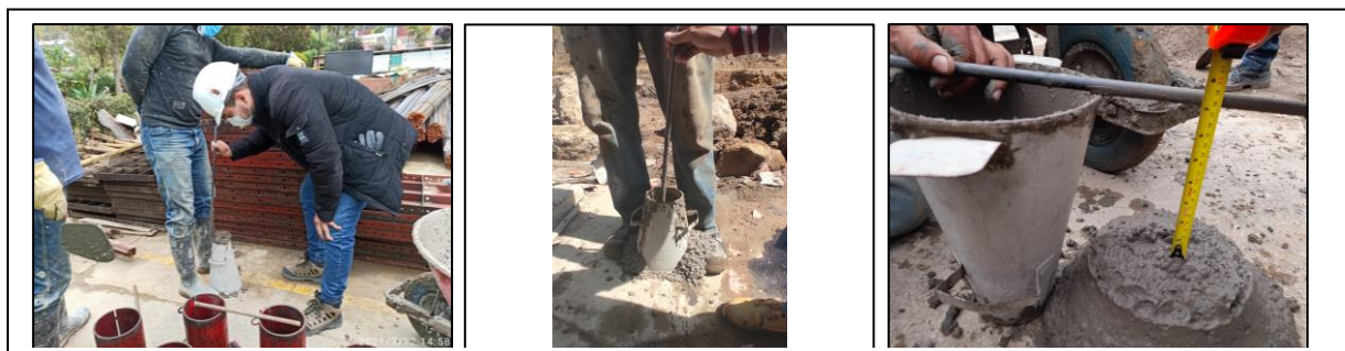
Ensayo de Slump Test
