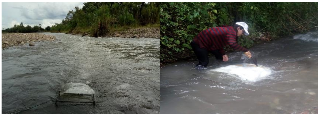
Fotografía 4. Trampas de sedimentos en cauce instaladas.
