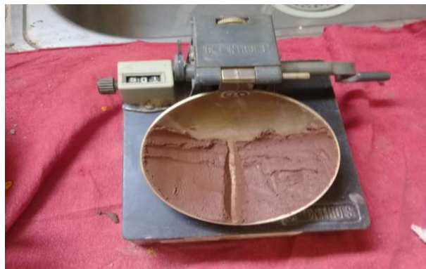
Fotografía 11. Equipo de limite liquido con muestra de suelo dividida.
