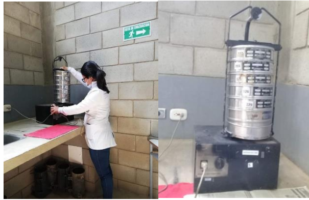
Fotografía 9. Juego de tamices y tamizadora utilizados en laboratorio.
