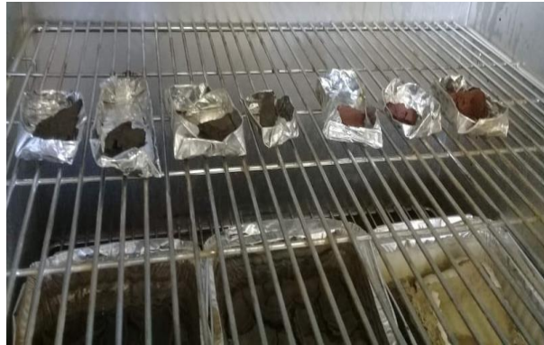
Fotografía 12. Muestras para ensayo de limite liquido en proceso de secado.
