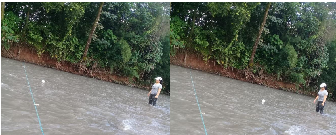
Fotografía 17. Aforo de caudal con el método de flotadores
