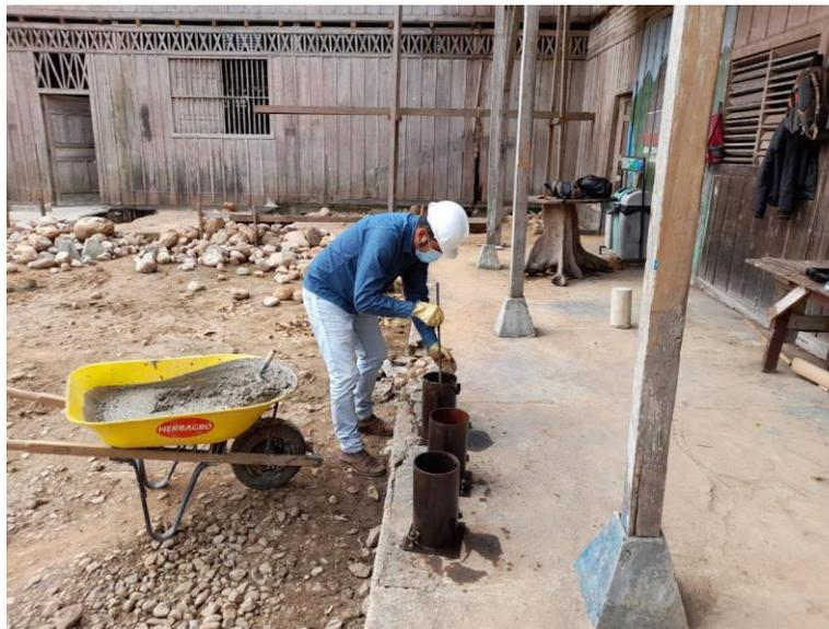
Ilustración 26 Compactación de cilindros
