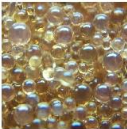
Fuente 8: Desmineralizadores.com Figura 7: Resina no Monoesferica
