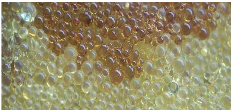
Figura 5: Características de una resina cationica y una resina anionica
