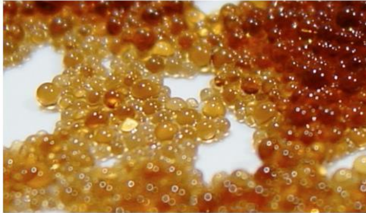
Figura 8: Perlas de resinas utilizadas en el tratamiento de aguas mediante intercambio ionico Fuente 9: Fluence News Team (2016)
