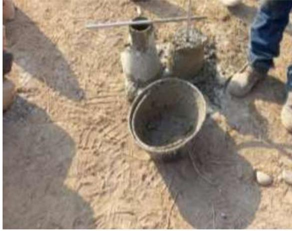
*Nota.* En la figura 27 se puede observar la muestra para la medición del asentamiento mediante método el cono de abrams.
