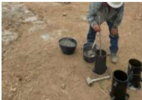
*Nota.* En la figura 28 se puede observar el llenado de las camisas para la elaboración de los especímenes de concreto para la prueba de resistencia a compresión.
