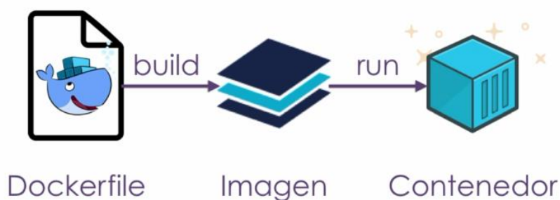
Ilustración 9. Flujo de construcción de un contenedor (Goig, 2016).
