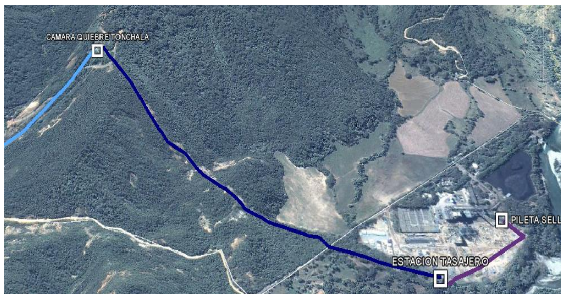
Ilustración 21 Impulsión Estación de Bombeo-Cámara de Quebre
