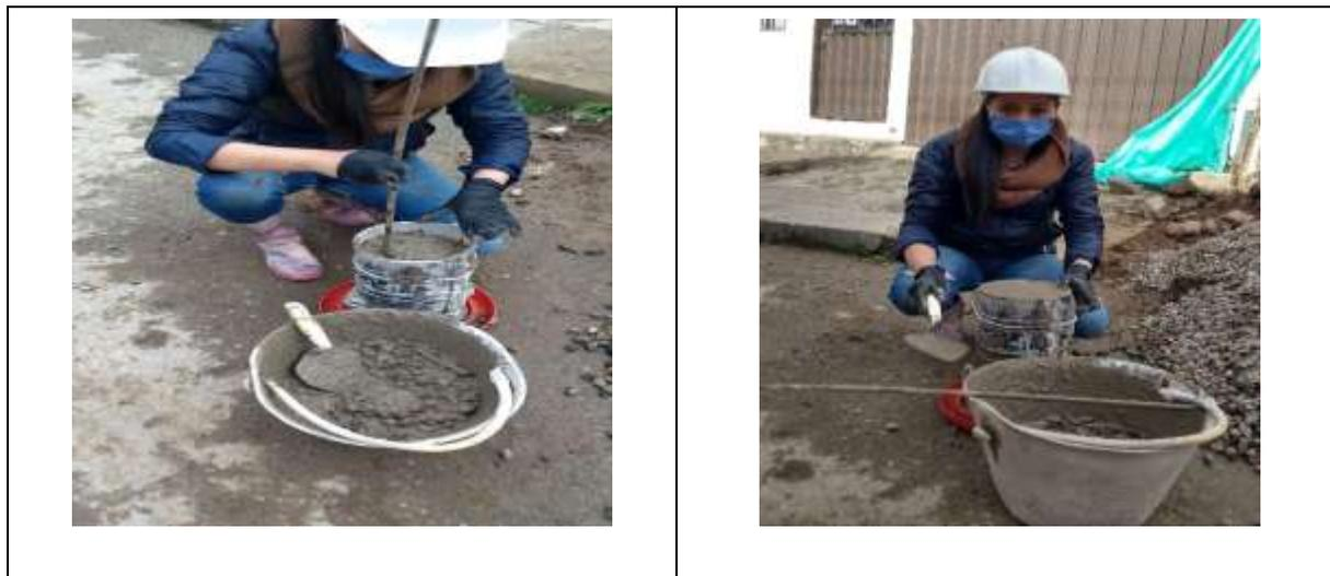
Se tomaron muestras representativas para hacerles el ensayo a compresión en la maquina universal buscando obtener la resistencia del mismo a los catorce y veintiocho días, se realizó en las instalaciones del ISER
