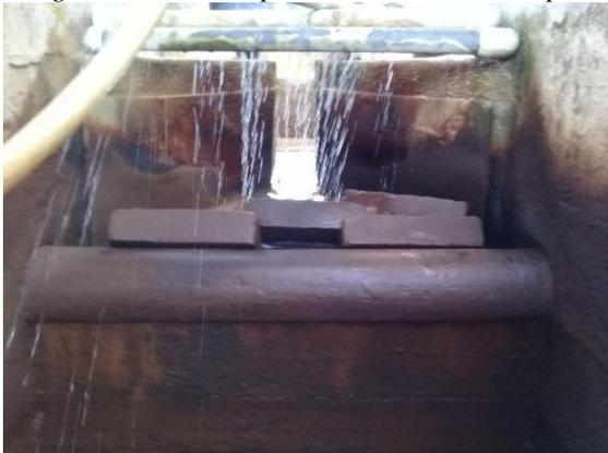
*Imagen 7. 61 Estructura para Realizar el Resalto Hidráulico.*
