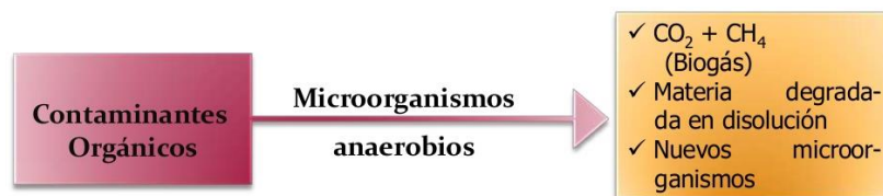
Figura 4. Proceso del tratamiento anaerobio
