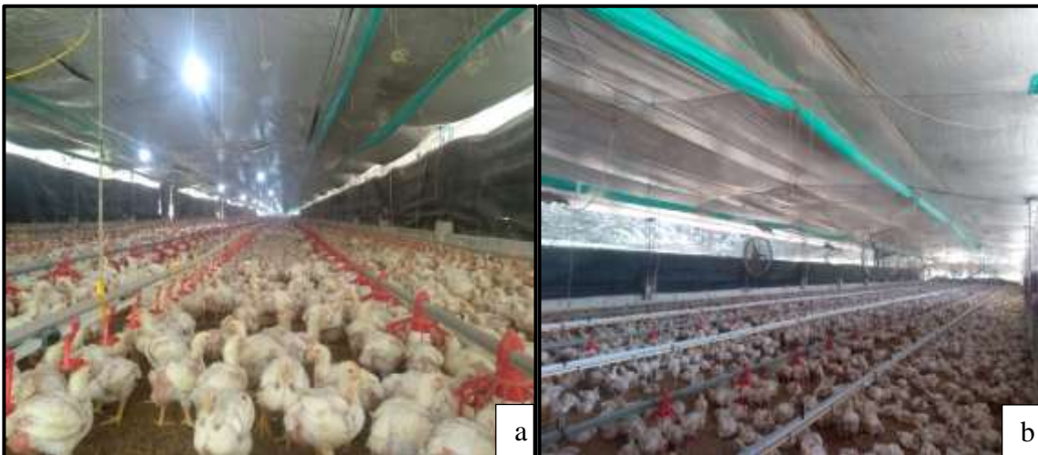
Figura 9. Área de equipos galpones granja Yucatán. a) Comederos automáticos, b) Bebederos automáticos de niple.
