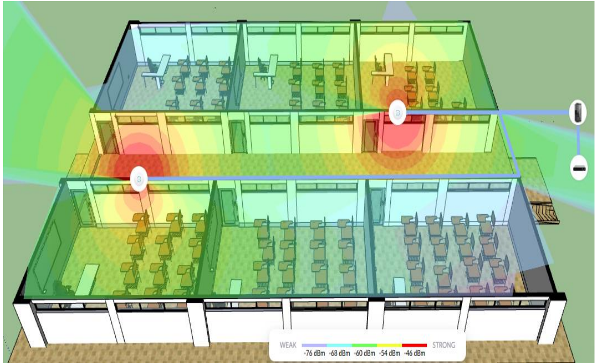
Figura 65 Mapa de Calor Bloque IC a 5 GHz
