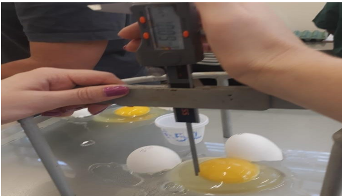
Figura 19. Altura de albúmina con micrómetro.
