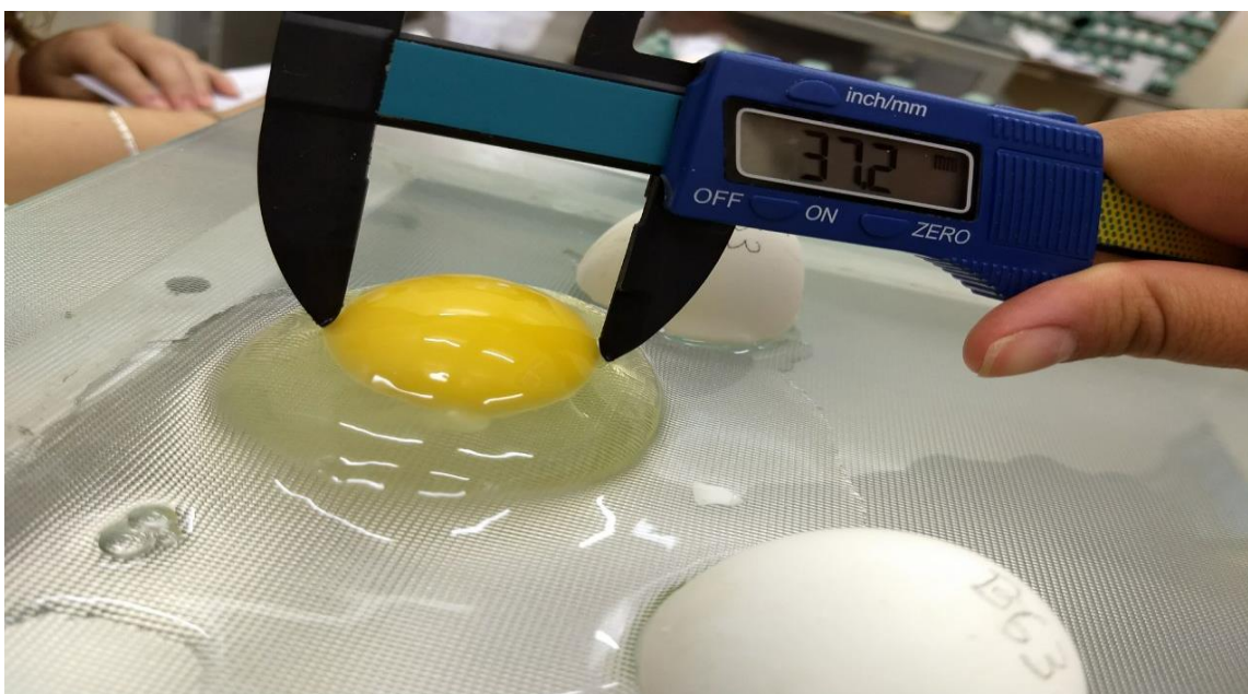
Figura 20. Diámetros de yema con paquímetro.
