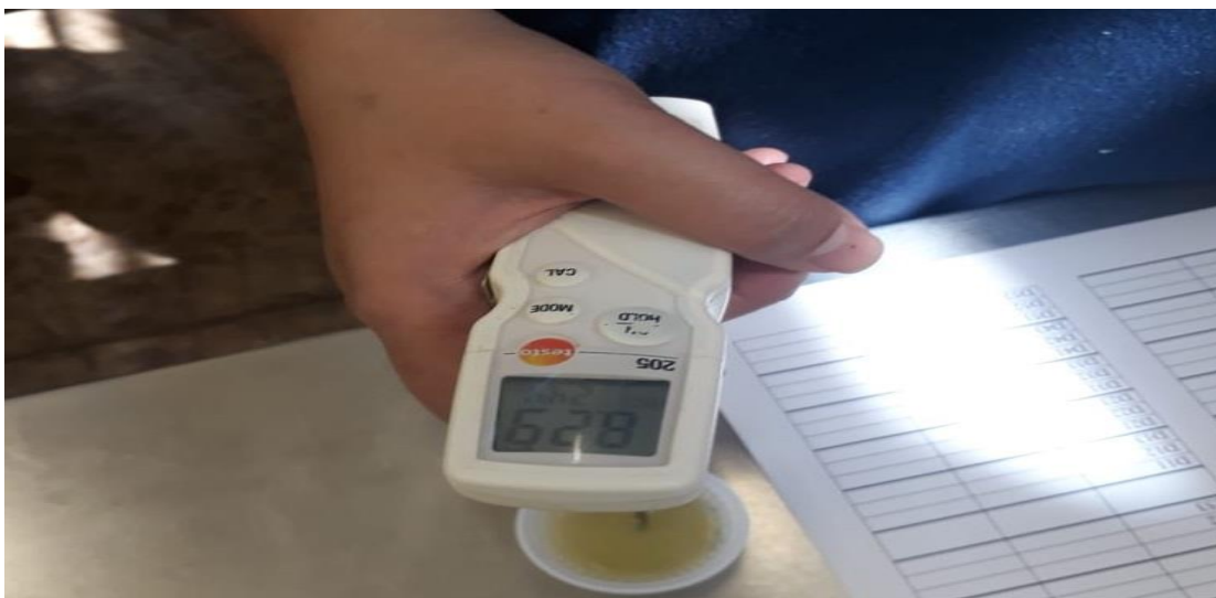
Figura 22. Medición del ph con el medidor de ph bancada portátil.
