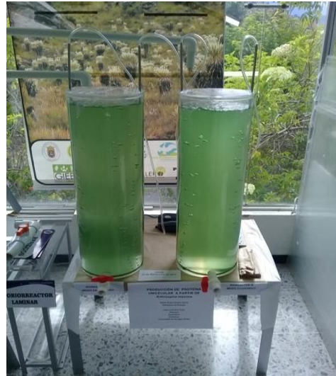
Figura 7. Fotoreactor Airlift día 1. Laboratorio Centro de Biotecnología. Universidad de Pamplona. Castillo, R. 2018.
