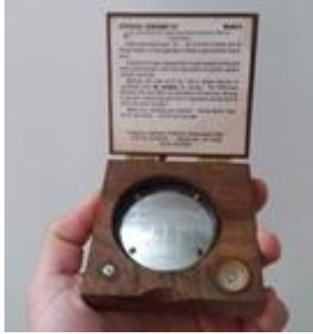
Figura 12. Densiómetro esférico. Instrumento portátil para medir el dosel de un sistema vegetal con base en el número de cuadrantes no ocupados por el reflejo de la cobertura vegetal.
