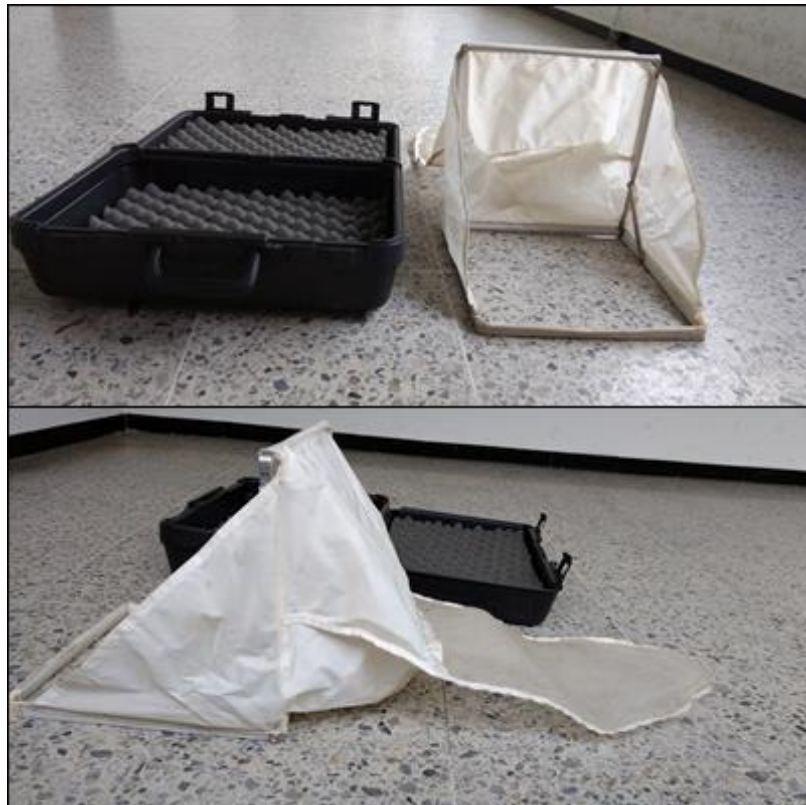
Figura 62. Red Surber de malla blanca con dos varillas de metal de 30.5 cm formando un cuadrado (Fotografía: ©Rojas, J., 2017).
