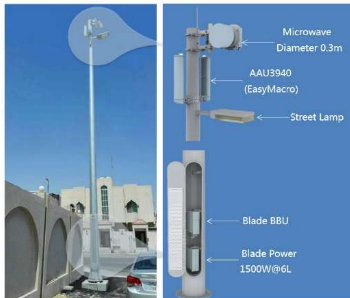
Ilustración 32. Sitio de poste 5G (micro celda).
