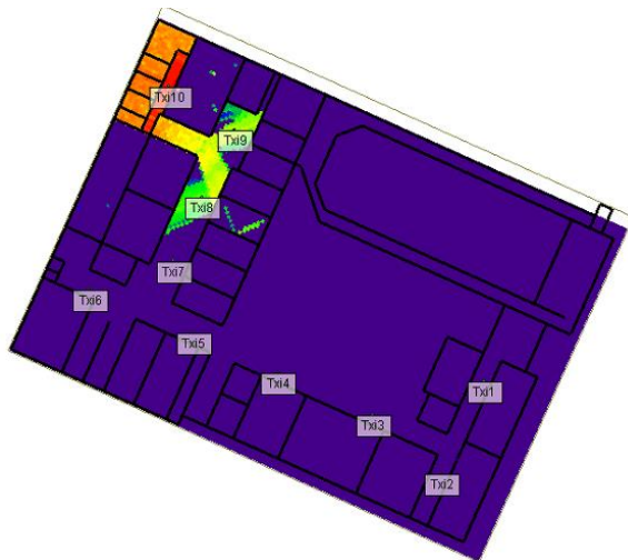
Figura 109. Cobertura Txi10 Diseño 1 Tercer Piso
