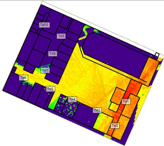
Figura 96. Cobertura Txi1 Diseño 1 Tercer Piso
