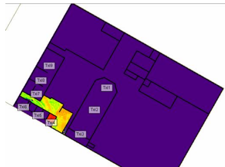
Figura 166. AP Tx14 Cobertura Diseño 2 Piso 1
