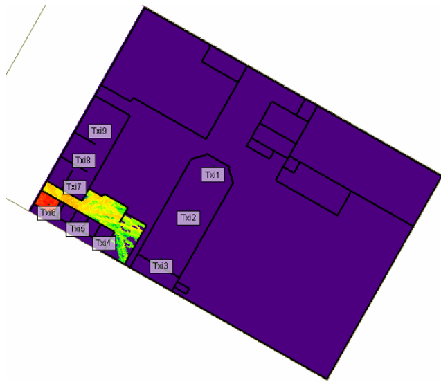
Figura 131. Cobertura Tx16 Diseño 2 Primer Piso
