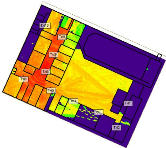
Figura 105. Cobertura Txi7 Diseño 1 Tercer Piso
