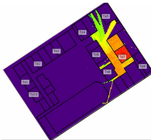
Figura 142. Cobertura Txi8 Diseño 2 Segundo Piso
