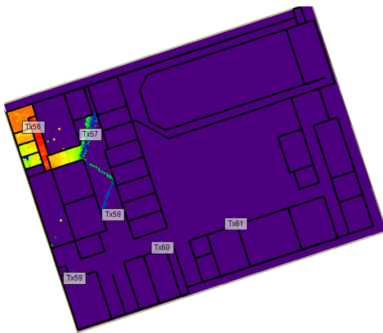
Figura 125. AP 56 Cobertura Actual Piso 3
