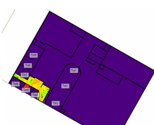
Figura 167. AP Tx15 Cobertura Diseño 2 Piso 1
