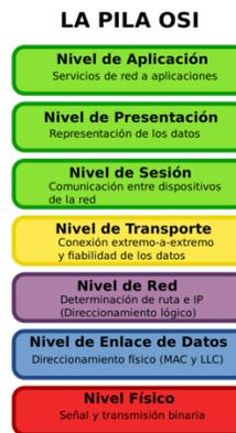
Figura 5. Estructura del modelo OSI.
