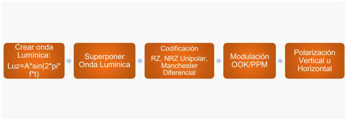
Figura 12. Diseño de la etapa de Transmisión
