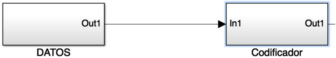
Figura 35. Subsistemas correspondientes al dato y al codificador NRZ.
