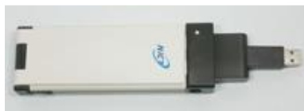
Figura 12. Prototipo USB-stick IEEE 802.11af
