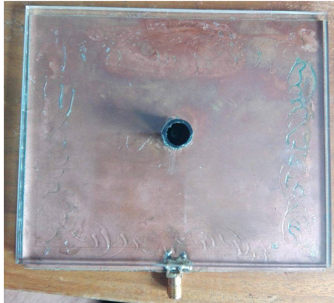
Figura 67. Antena implementada, capa inferior
