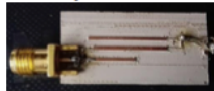
Fig. 12 Líneas de acople de entrada
