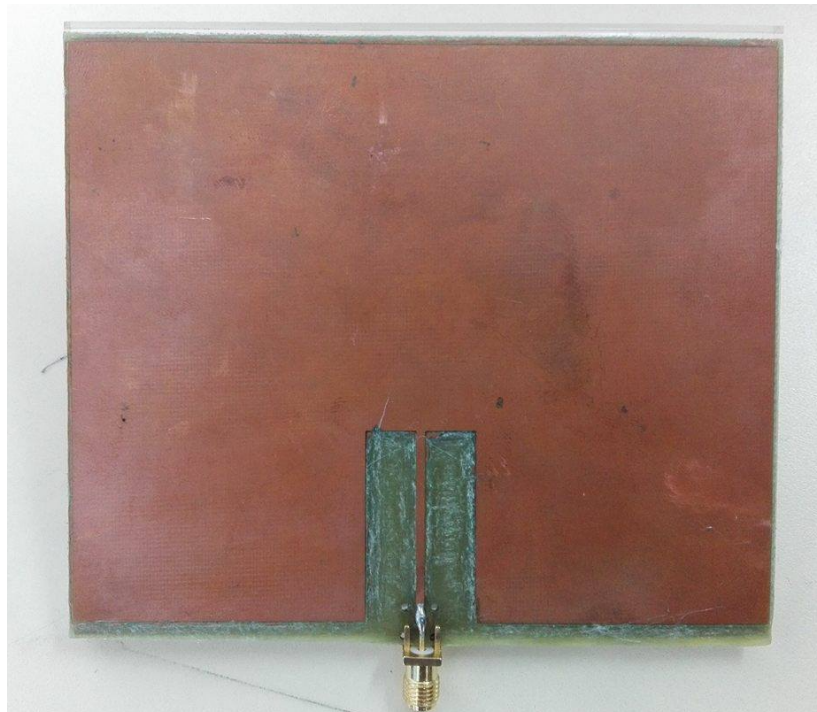
Figura 66. Antena Implementada, capa superior
