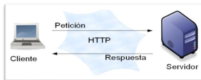
Figura 13 Esquema y respuesta mediante HTTP entre cliente y servidor
