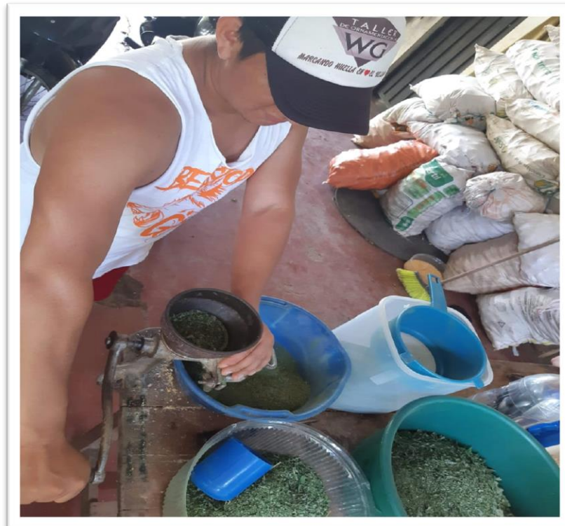
Imagen 4. Proceso de molido manual de hojas de G. sepium. (Mendoza, 2020)
