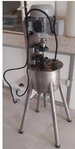
Ilustración 18. Reactor Batch pequeña escala, secuencia fotografía
