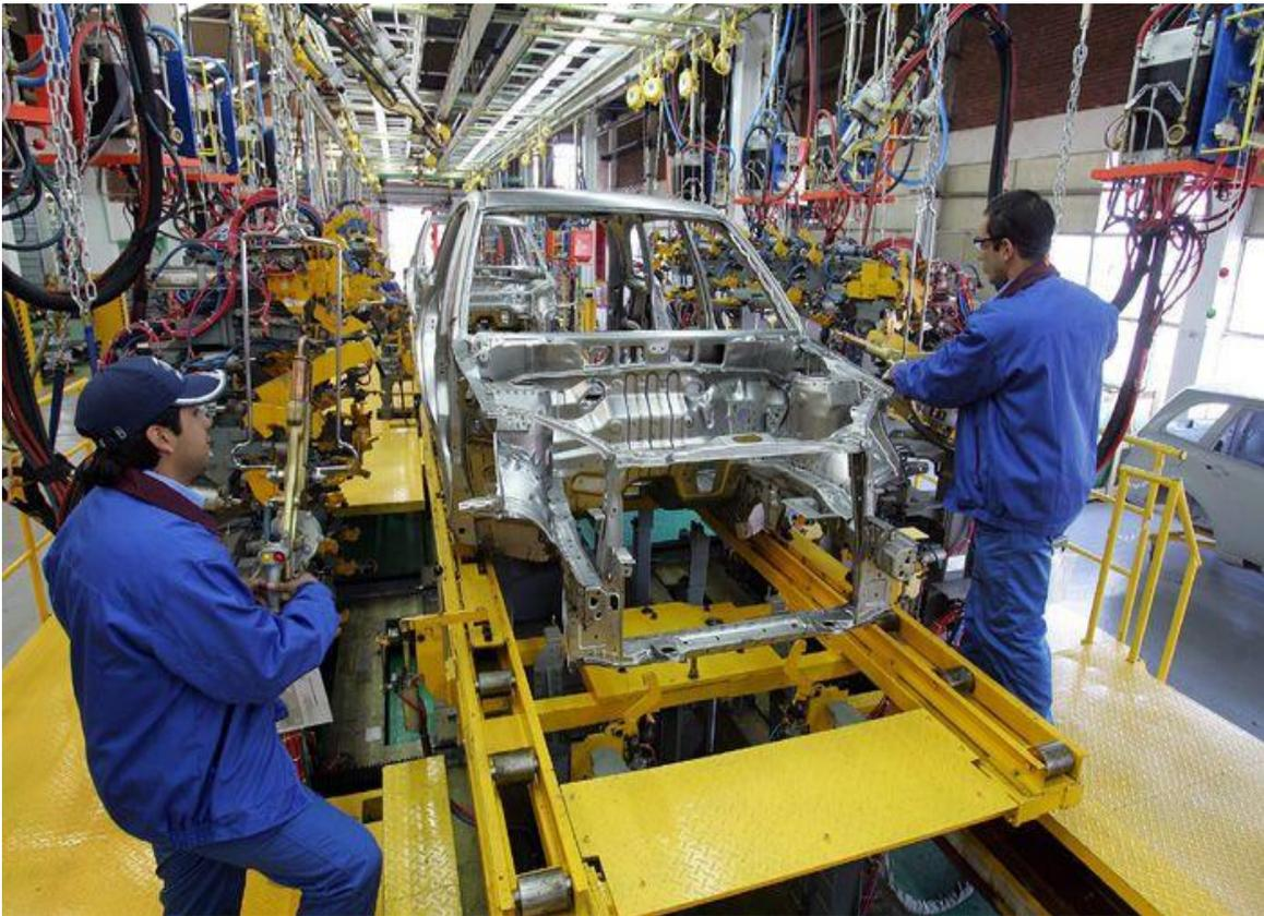
Ilustración 8. Procesos de fabricación de un automóvil
