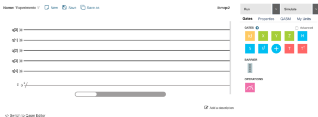
FIGURA 2.13: Interfaz gráfica del IBM Q denominada Quantum composer, sobre la cual es posible crear circuitos cuánticos utilizando una librería de compuertas lógicas y puntos de medición preestablecidos. (tomado de [44])
